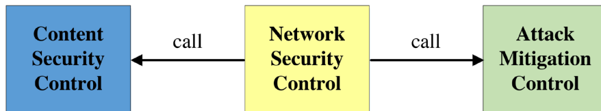
그림 3. I2NSF 기능 계층 인터페이스를 위한 정보 모델
